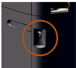
Podłączenie przelewu z tyłu zmiękczacza wody
